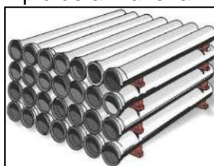
Figura 5 – Exemplo de armazenamento de tubos.
